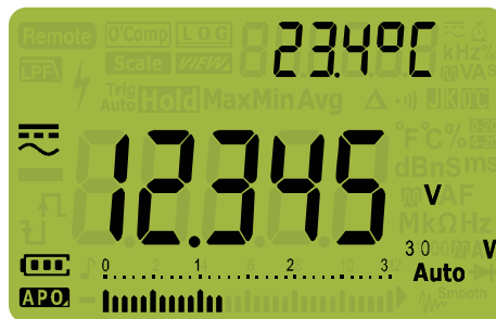
Figura 2-7 Exibição de tensão CA+CC
