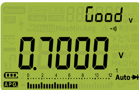
Figura 2-22 Exibição do diodo automático - Status: Good (Bom)
