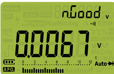
Figura 2-23 Exibição do diodo automático - Status: nGood (Não é bom)
