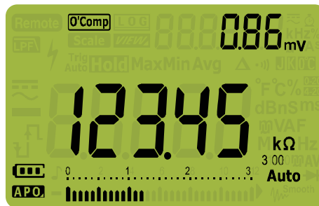
Figura 2-16 Exibição Smart \Omega (com tensão de polarização)
