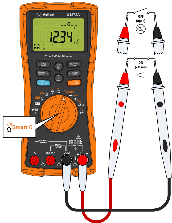
Figura 2-15 Testar a continuidade
