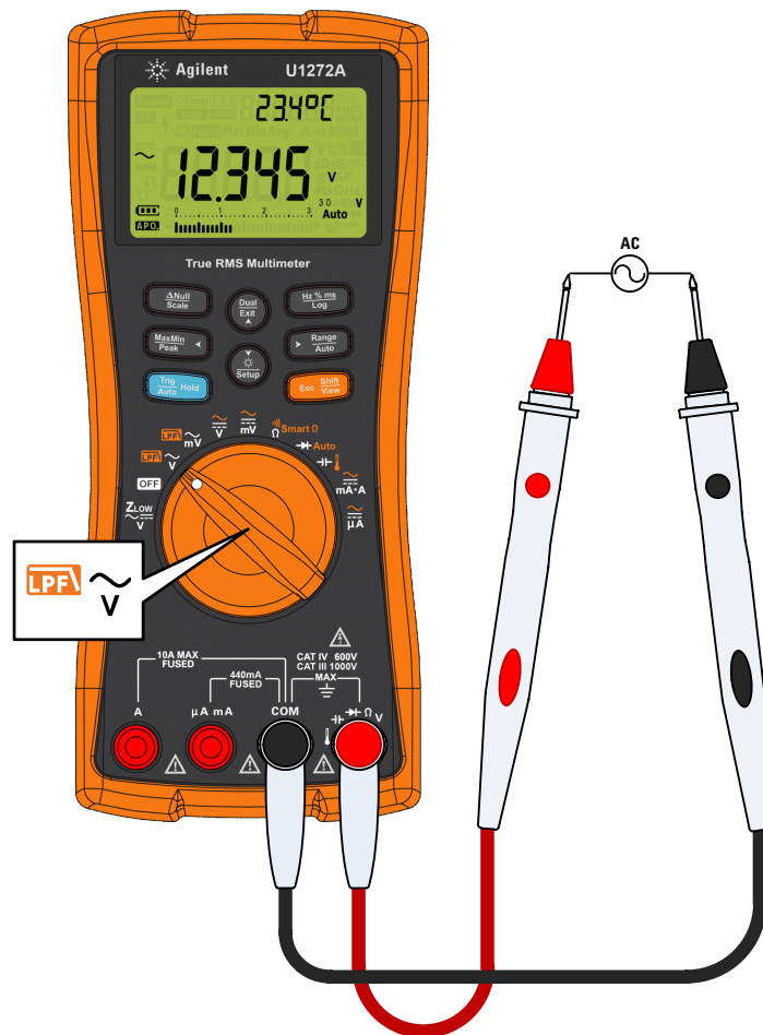
Figura 2-2 Medir a tensão CA
