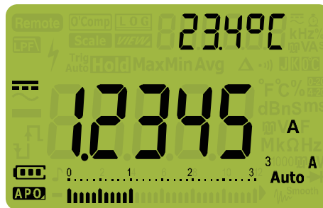
Figura 2-29 Exibição de corrente CC
