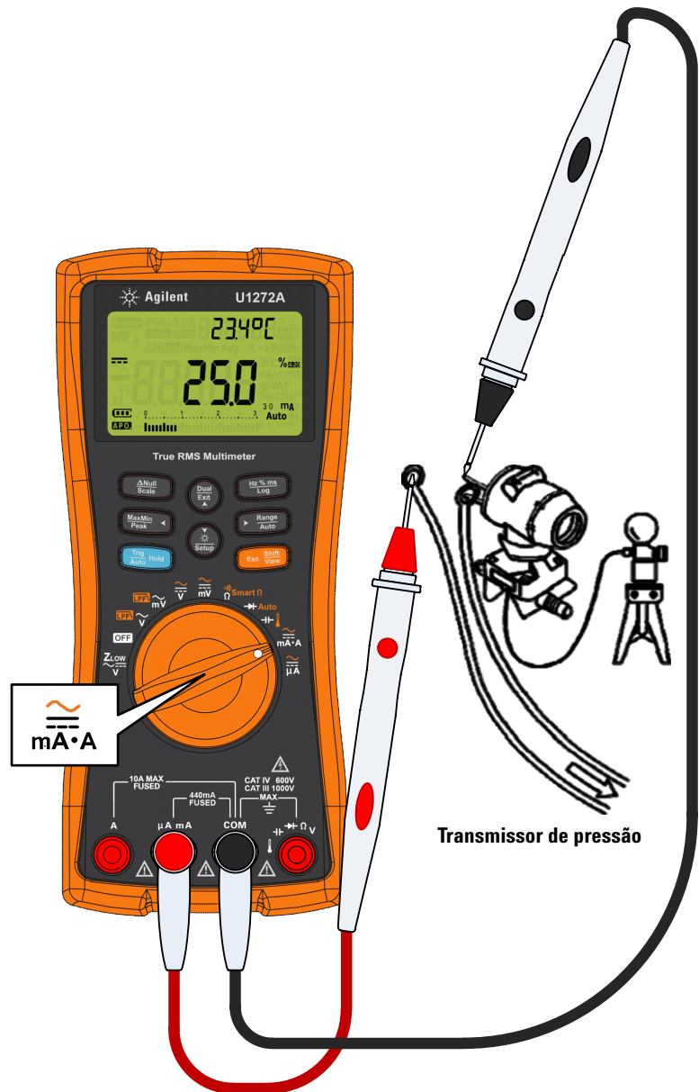
Figura 2-34 Medir a corrente CC usando a escala % 4–20 mA
