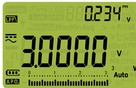
Figura 2-4 Acoplamento CC para medições de tensão CA+CC
