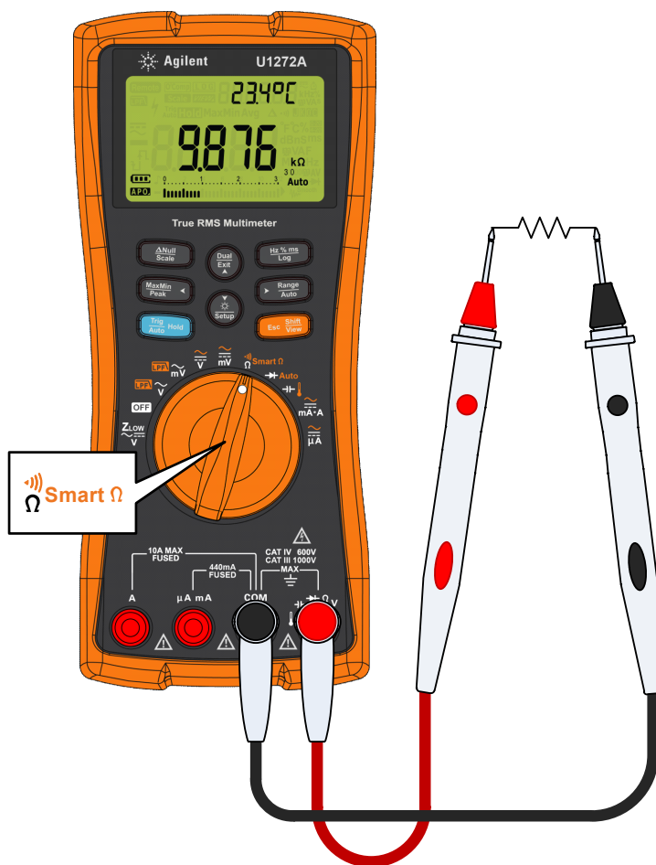
Figura 2-13 Medir a resistência
