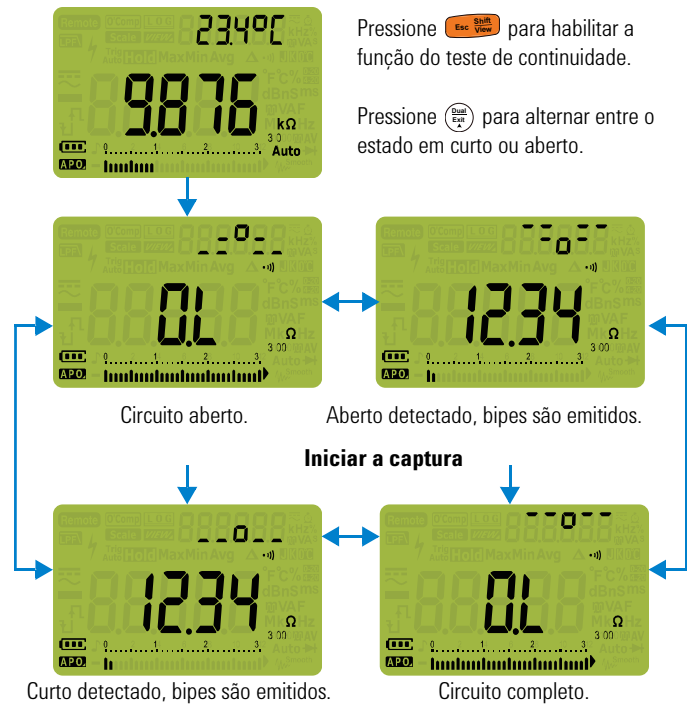
Figura 2-14 Operação de continuidade
