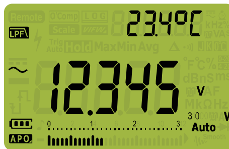
Figura 2-3 Tensão CA com a exibição do LPF
