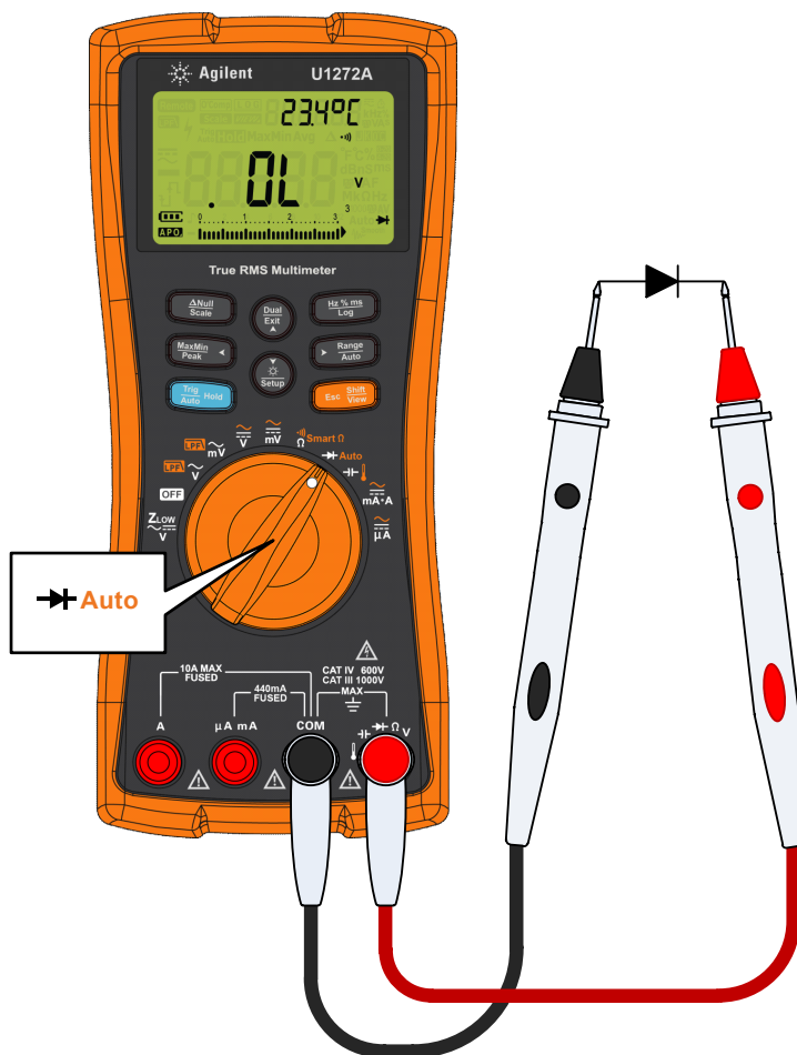
Figura 2-21 Testar o diodo de polarização reversa
