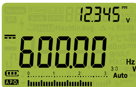
Figura 2-37 Exibição de frequência
